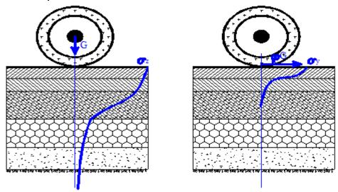
Напряжения от колёс автомобилей в дорожной одежде затухают с глубиной, что позволяет проектировать её многослойной, применяя в отдельных её слоях материалы различной прочности.
